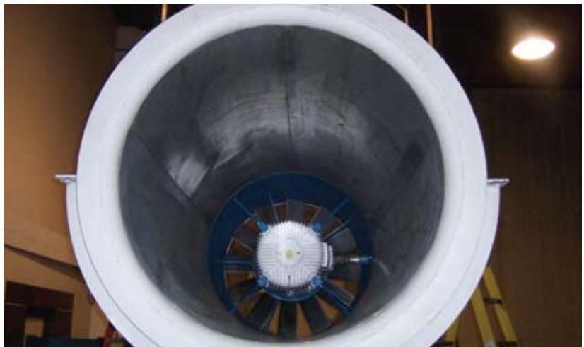
LA Metro jet fan in the AMCA 250 test rig.
